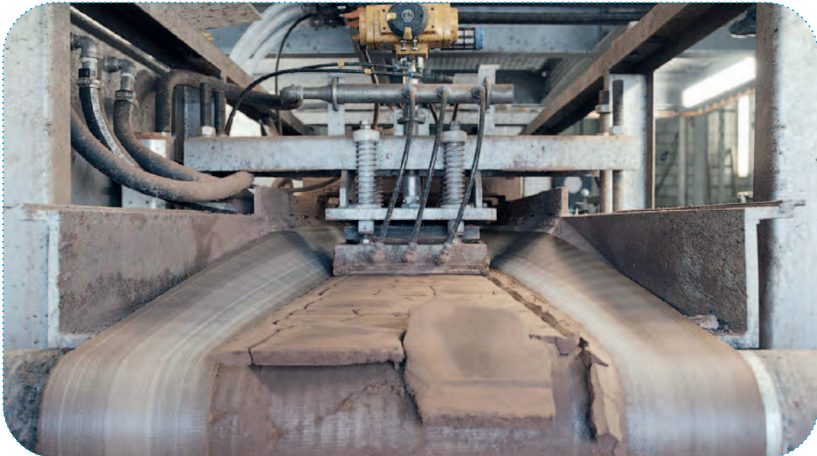
REALphos Pilotanlage: Filterkuchen auf Vakuumbandfilter
