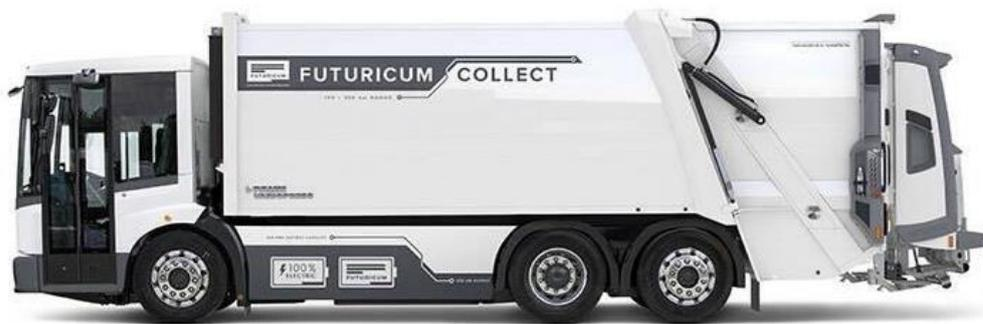
**Bildlegende:** 3-Achser-Elektro-Kehrichtfahrzeug Futuricum mit Niederflerkabine
